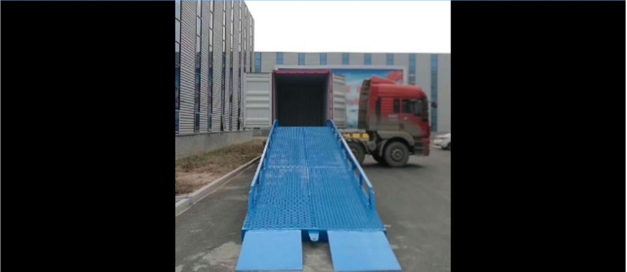
登车桥上下两层运输间层高立体车库和地下车库汽车登车桥等各种商品之间的主要工作。液压系统设置属于保护产品，过载保护装置，各楼层和工作台面固定，可设置登车桥操作按钮，实现多点控制。坚固的结构，承载能力大，登车桥平稳，安装维修方便，是经济实用的替代电梯楼层之间，低的理想货物运输设备。根据固定登车桥的安装环境和使用要求，选择不同的可选配置，可以达到更好的效果。登车桥采用新型强度铝合金为原料，强度高，比较小的偏转和挥杆特点。
