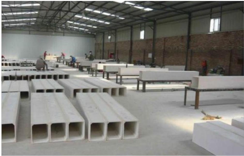
住宅排烟道道系统按结构特征可分为等截面排气管道系统和变截面排烟道道系统，前者自上而下为等径排气道，其优点在于结构简单、通用性强、制作安装方便；后者排气道截面尺寸自下而上逐级增大 $\square SVS VS \square$ ，其优点在于可以节约建筑空间，但需要的排气道规格相对较多。在排气道外壁与预留孔洞缝隙间的填充混凝土或砂浆固结而成，用于承受其上排气道及其附属结构的重量等荷载。由于现场安装施工情况复杂、不确定因素较多，在计算时应该考虑承托件的承载能力，要求其能够可靠支承作用于其上的荷载，而不考虑混凝土的协同承载能力，其计算结果将偏于安全。
